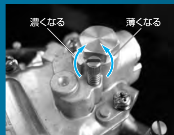
●加速ポンプアジャスティング 他のホリゾンドラフトキャブレターでは、エンジンに装着したままでのポンプの吐出量調整が非常に困難でしたが、このスクリューを廻すだけで容易に増減できます。
