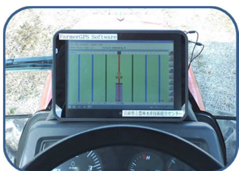
トラクター運転席前のモニターに ガイダンスラインを表示
